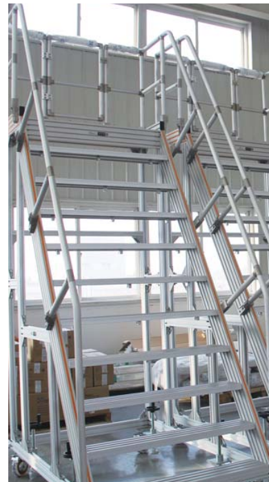
Plataforma de mantenimiento
