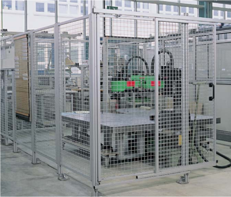
Barreras de proteccion para maquinas
