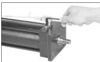
Atornillar el sensor en el cilindro.
