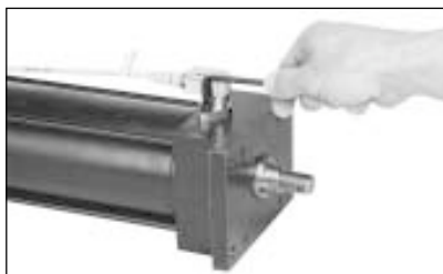
Atornillar el sensor en el cilindro.
