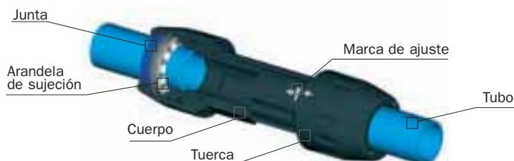
Los racores de unión de Ø 16,5, Ø 25 y Ø 40 se conectan de forma instantánea al tubo de aluminio Transair®. Basta con introducir el tubo en el racor
