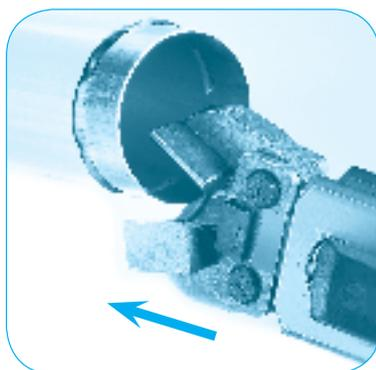
Abrir manualmente las dos mordazas de la pinza. Insertar el tubo de aluminio en la pinza hasta el tope.
