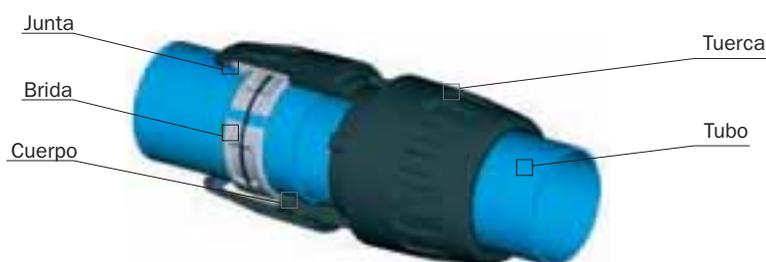
Los racores de unión Ø 63 se conectan al tubo de aluminio Transair® mediante una doble brida. Esto hace solidarios al racor y
